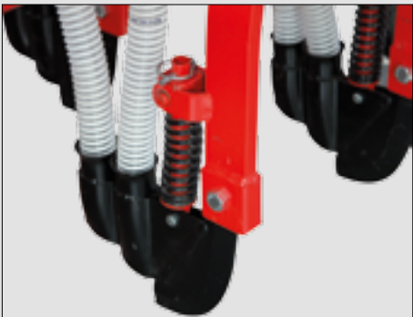
Spring axle type sowers 弹簧斧子型的播种开沟器
